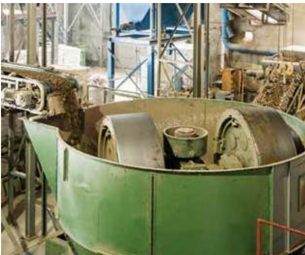
Kollergang, zwei schwere Walzen zerkleinern den Ton
