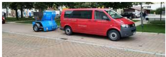
CPX-Rollgeräuschmessung mit genormten Reifen direkt an der Fahrbahnoberfläche
