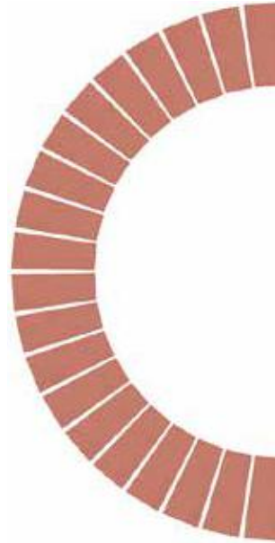
Abb. A5-7: Baumscheibe mit Keilklinkern
