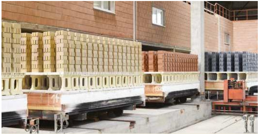
Tunnelofenwagenbesatz mit Pflasterklinker
